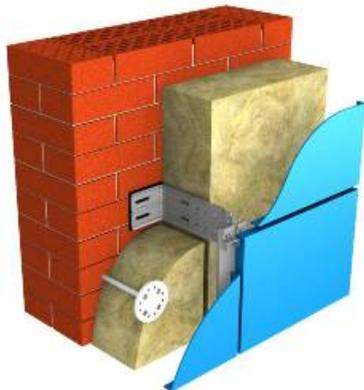
Утеплитель, находящийся с наружной стороны здания, обеспечивает сохранение тепла в несущих строительных элементах и шумоизоляцию, способствует сохранению оптимальной комфортной температуры в помещениях, уменьшает
