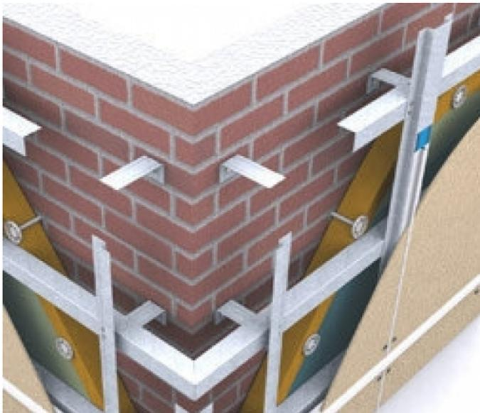
Вентилируемый фасад представляет собой конструкцию из металла, утеплителя, панелей, он крепится на стену здания. Элементы его универсальны, это позволяет решать наиболее сложные задачи. Существуют сертификаты качества на материалы, а стоимость рассчитывают индивидуально. Дом после отделки становится термосом, который удерживает тепло в 5 раз лучше, нежели без вентфасада. Летом фасад позволяет сохранять прохладу, улучшает звукоизоляцию.
