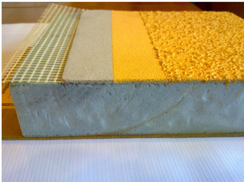
Декоративный слой мокрого фасада предназначен для защиты и декора фасадной системы. Данный слой обладает защитными функциями, благодаря ним фасад (утеплитель) оберегается от внешних воздействий, а именно: от ветра, атмосферных осадков, мороза, разной химии, ультрафиолета и т.д.
